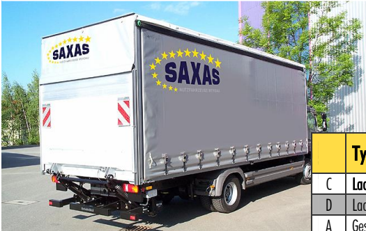
Pritschenaufbau Typ MPS - M passend auf Fahrgestelle 7,49 - 15 t zGG
